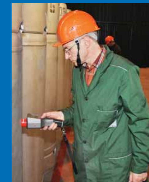
Измерение концентрации U-235 в контейнере при проведении инспекции МАГАТЭ.
